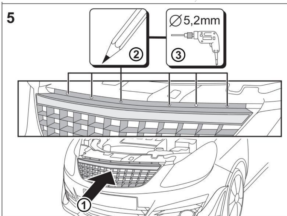
5. Размечаем и просверливаем отверстия в верхней части бампера для пистонов крепления
