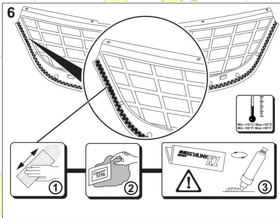
6. Наносим герметик по контуру прилегания новой решетки
